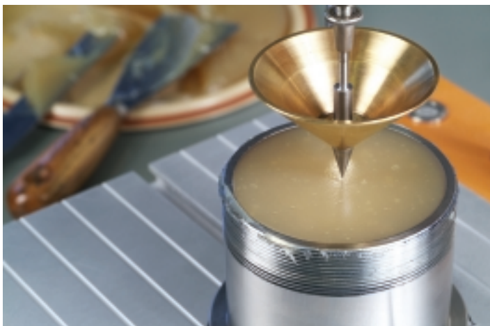
Im Labor: Penetrometer zur Bestimmung der Konuspenetration bei Schmierfetten. Dabei wird eine Aussage über die Konsistenz eines Schmierfettes getroffen. Der Kennwert der Prüfung ist die Eindringtiefe (Penetration) eines frei fallenden Normkugels in eine Fettprobe.
