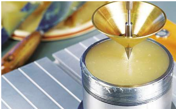
Bild 2: Die Eigenschaften von Schmierfetten müssen überprüft werden können. Ein Verfahren dazu ist die Konuspenetration mit einem Penetrometer.
